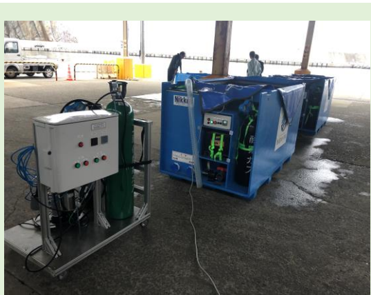
▲4月17日わかごう漁協における活魚運搬システム「魚活ボックス」のデモンストレーション。二酸化炭素を溶け込ませ調整された海水に魚を入れ、睡眠状態にして輸送することで、輸送コストを大幅に削減でき新鮮なまま出荷することができる。今後の販路開拓に期待
